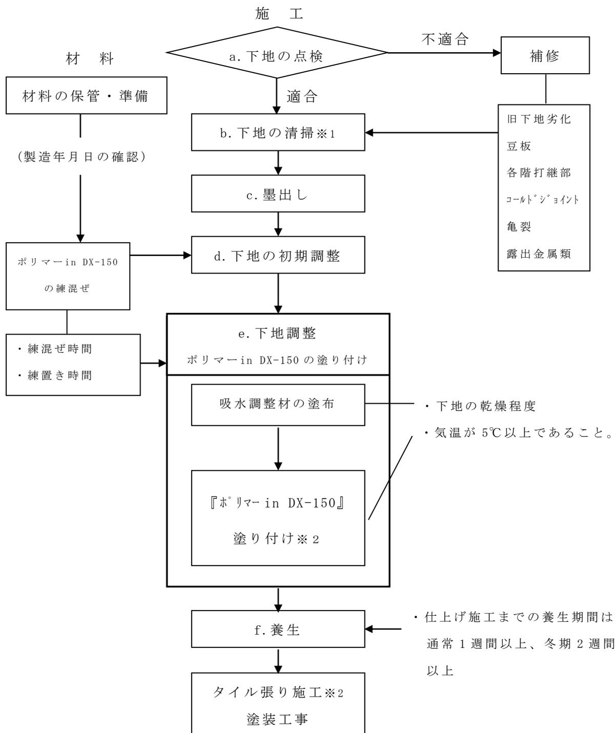
※1 塗装合板型枠下地は高圧洗浄を推奨します。
